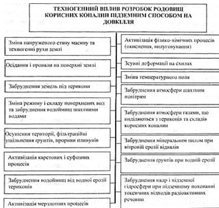
Рис. 1. Вплив на довкілля від розробки родовищ корисних копалин підземним способом
