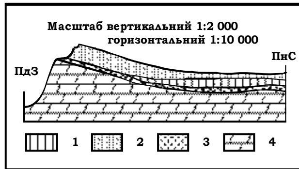
Рис. 67. Здолбунівське родовище крейди (схематичний геологічний розріз за матеріалами Д.Кожевина, 1954)
