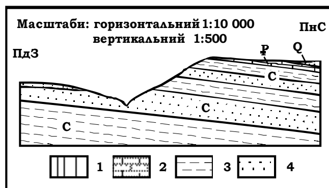
Рис. 53. Браунівське родовище пісковиків і вапняків (схематичний геологічний розріз за матеріалами А.Резніка, 1959) 1 – ґрунт, піски, суглинки; 2 – вапняки; 3 – аргіліти, алевроліти, сланці; 4 – пісковики
