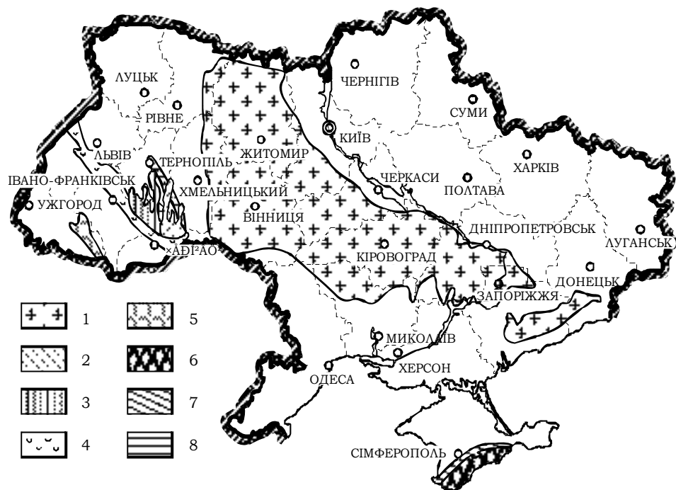
Рис. 55. Карта перспективних площ декоративного камення України 1 – породи кристалічного фундаменту (граніти, гнейси та ін.); 2 – вапняки силурійські, мармуризовані; 3 – пісковики девонські; 4 – гіпс неогеновий; 5 – мармури, вапняки тріасові, юрські і туфи неогенові; 6 – вапняки юрські, мармуризовані; 7 – вапняки крейдові і палеогенові; 8 – вапняки неогенові
