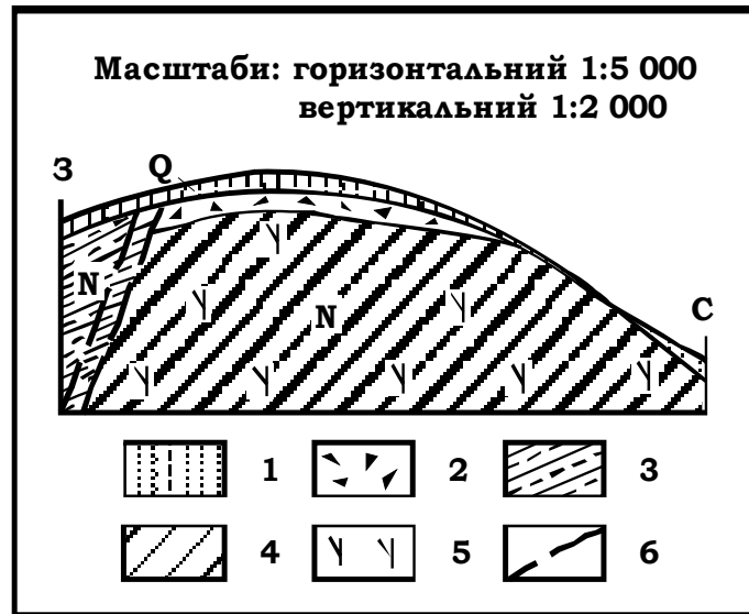
Рис. 74. Родовище Ковацьке, туфи (за матеріалами К.Геращенко) 1 – ґрунт, суглинки; 2 – кора вивітрювання; 3 – аргіліти; 4 – продуктивна товща; 5 – туфи; 6 – тектонічні порушення
