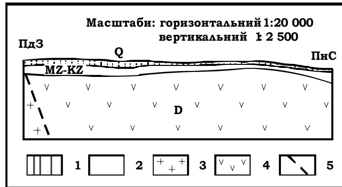
Рис. 54. Родовище базальтів Балка Камішеваська (схематичний геологічний розріз за матеріалами В.Корсун, 1964)
