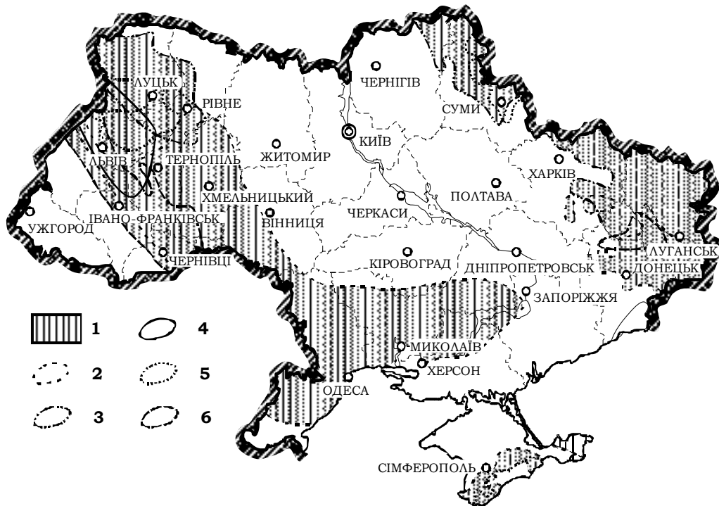
Рис. 66. Карта перспективних площ України на в'язучі матеріали 1 – перспективні площі, 2 – вапняки, 3 – крейда, 4 – мергелі, 5 – глини, 6 – гіпс
