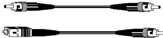
Рис. 3.30. Приклади одноволоконних оптичних шнурів з різними з'єднувачами
