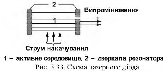
Рис. 3.33. Схема лазерного діода
