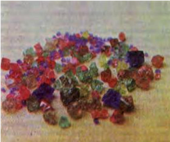
Різнозабарвлена шпінель, вирощена методом флюсу
