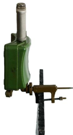
Рис. 49. Встановлення міни МОН-50 на дереві та металевому листі (а – на дереві; б – на металевій пластині; 1 – електродетонатор ЕДП-р; 2 – міна; 6 – струбцина; 7 – дерево; 8 – підрильник ВЗД-6Ч; 9 – металева пластина).
