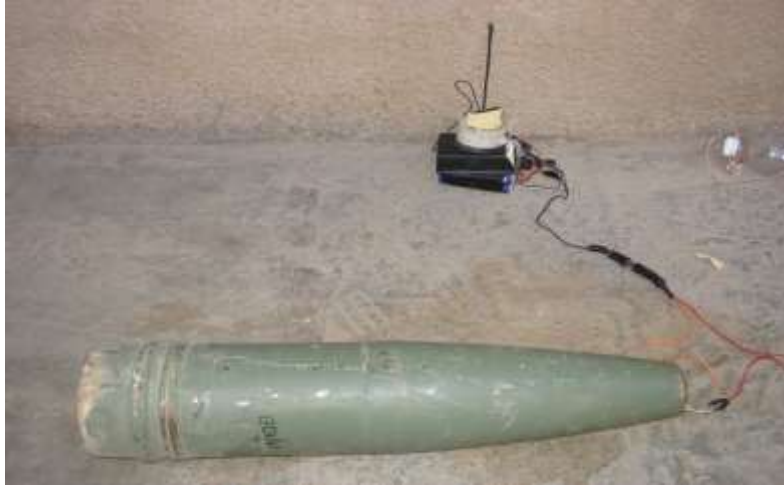
Рисунок 3.16 – СВП керований по радіо
