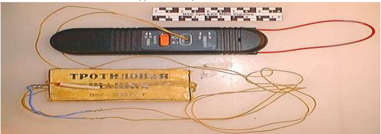
Рисунок 3.14 – Ємкісний датчик цілі
