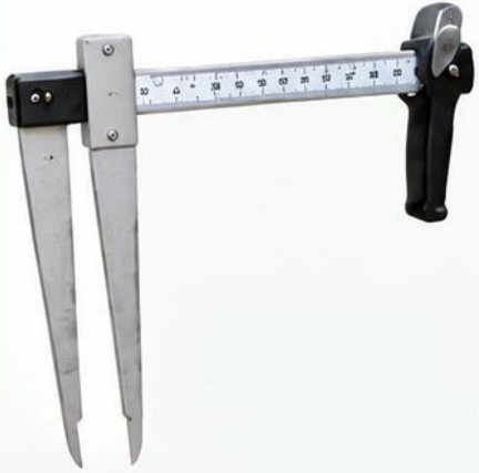
Мірна вилка (діаметральна) з лінійною шкалою
