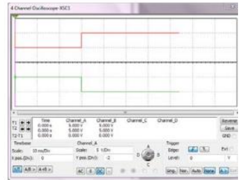
Рис. 10.26. Результати моделювання схеми дослідження RS-тригера з інверсними входами при розімкненому ключі S1, отримані за допомогою індикаторів (а) та осцилографа (б)
