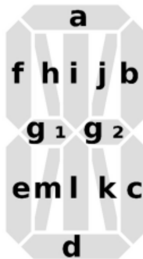
Рис. 6. Позначення сегментів чотирнадцяти розрядного індикатора
