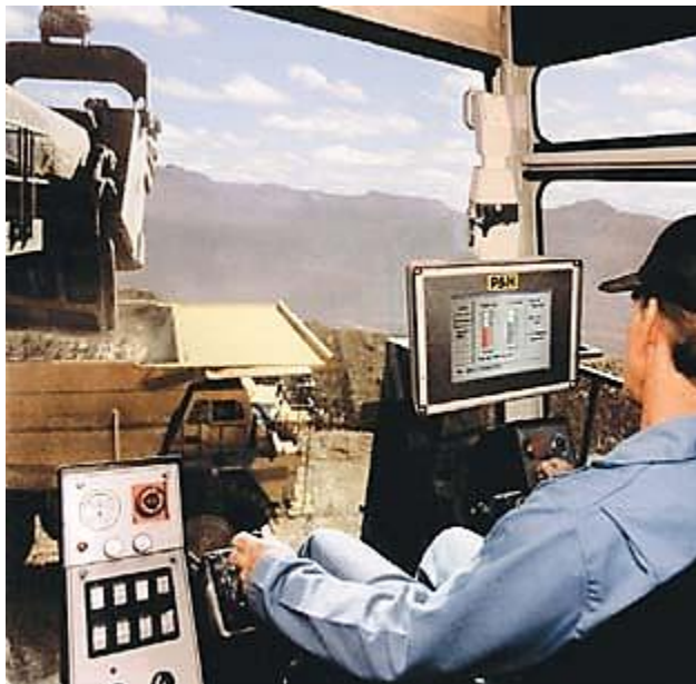
Рис. 5. Кабіна машиніста екскаватора Р&Н з графічним інтерфейсом керування
