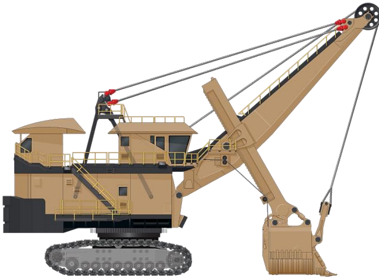
Рис. 4. Кар'єрна механічна лопати з рейковим напором компанії Р&Н
