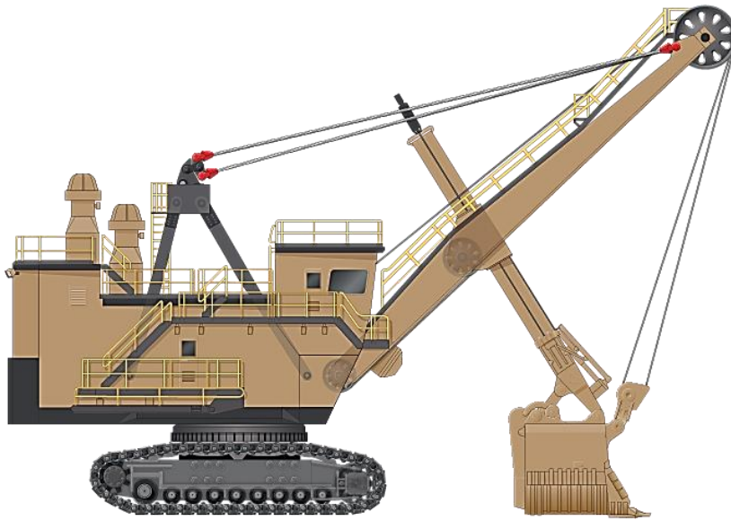
Рис. 3. Екскаватор компанії Bucyrus з канатним напором
