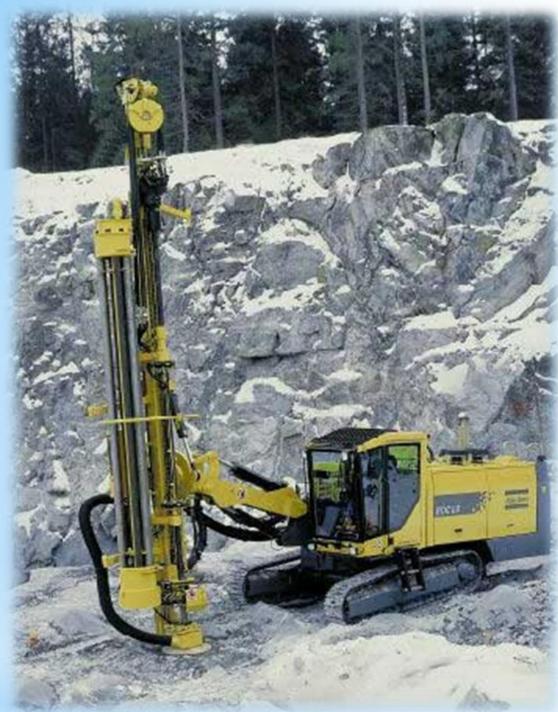
Рис. 1. Буровий верстат “Atlas Copco” для буріння свердловин на кар’єрі: а - вертикальних; б - горизонтальних
