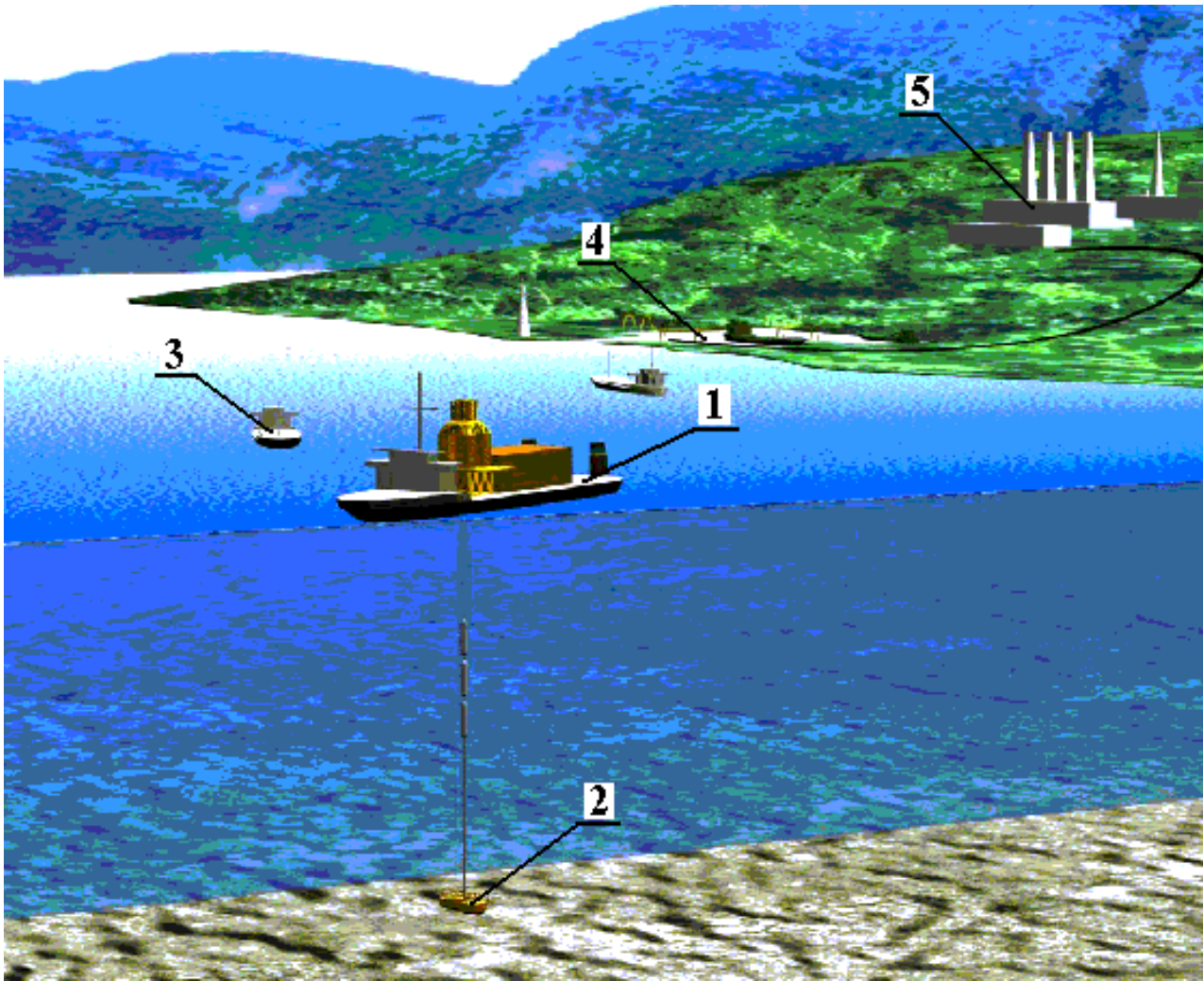
Рис. 10.1. Загальний вигляд гірничого підприємства з видобутку і переробки ЗМК: 1 – судновидобувний комплекс; 2 – агрегат збирання конкрецій; 3 – транспортне судно; 4 – портовий комплекс; 5 – комплекс металургійної переробки
