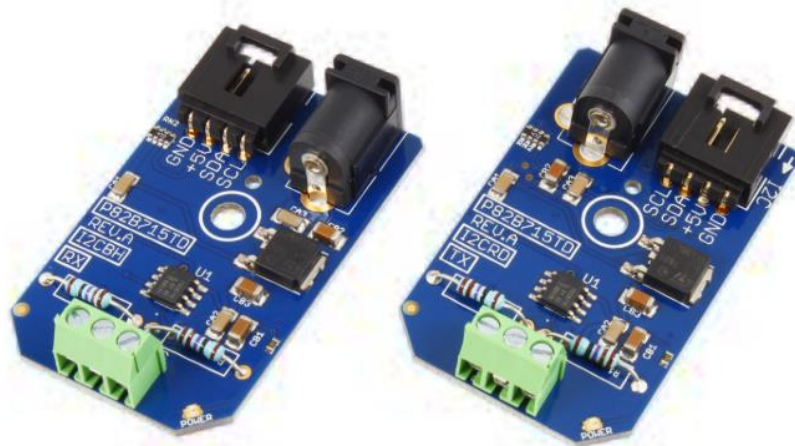
Рис. 2.6 – Модуль I2C Long Cable Extender на базі мікросхеми P82B715
