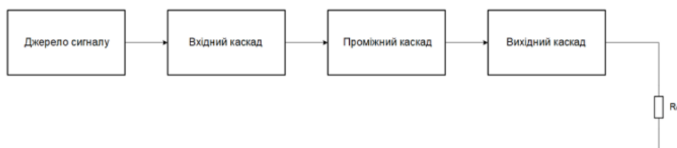
Рис. 6.1. Структурна схема вимірювального підсилювача
