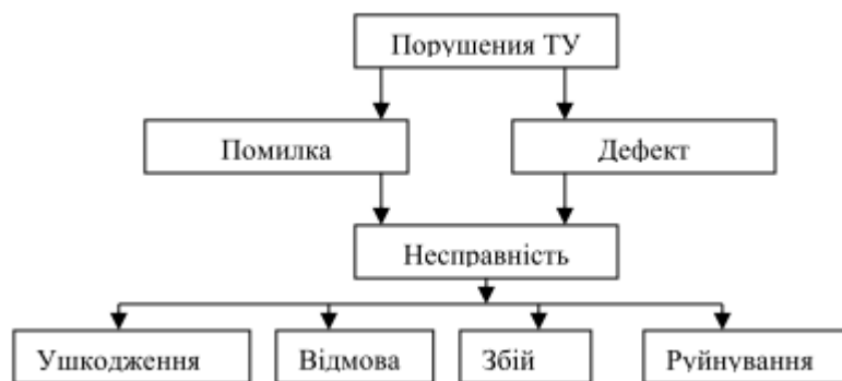
Рис.2.1. Структурно-логічна схема несправних станів
