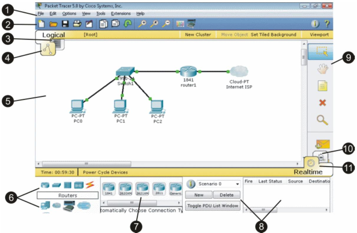
Завдяки такій властивості Cisco Packet Tracer, як режим візуалізації, користувач може відстежити переміщення даних по мережі, поява і зміна параметрів IP-пакетів при проходженні даних через мережеві пристрой, швидкість і шляхи переміщення IP-пакетів. Аналіз подій, що відбуваються в мережі, дозволяє зрозуміти механізм її роботи і виявити несправності.
