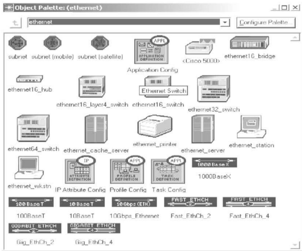
Opnet Modeler - сучасне середовище моделювання, здатне до моделювання поведінки мережевих процесів (протоколи комунікації), мережевих компонентів (сервери, автоматизовані робочі місця, вимикачі, маршрутизатори, тощо), додатків (HTTP, FTP, електронна пошта, VoIP, база даних, тощо) та їх розширених комбінацій (підмережі, виправлені і бездротові мережі, тощо).
