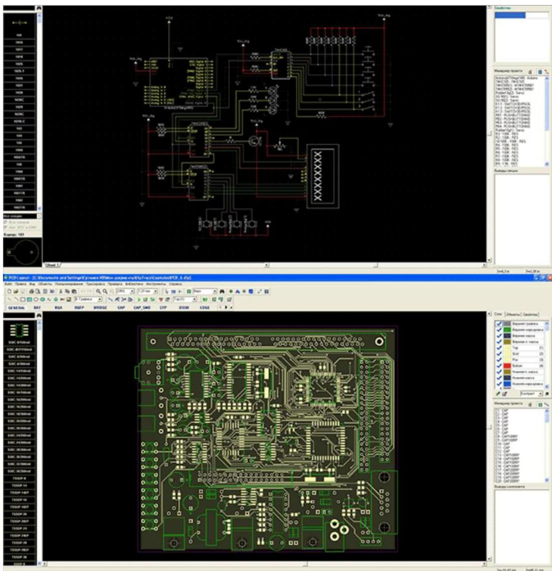
5.3. Пакет *DesignLab* – це інтегрований програмний комплекс для автоматизації проектування аналогових, цифрових, а також змішаних (аналого-цифрових) пристройів, синтезу пристройів програмувальної логіки і аналогових фільтрів. У цьому пакеті проектування починається з введення принципової схеми пристрою, її моделювання й оптимізації та закінчується створенням керуючих файлів для програматорів, а також для фотоплоттерів і свердлильних верстатів з метою створення печатних плат.
