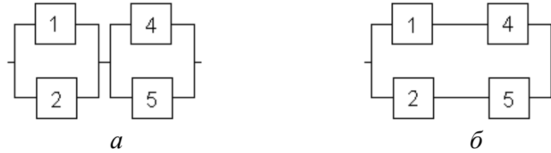
Рис. 5.5. Перетворення місткової схеми при абсолютно надійному (а) та такому, що відмовив (б) центральному елементі
