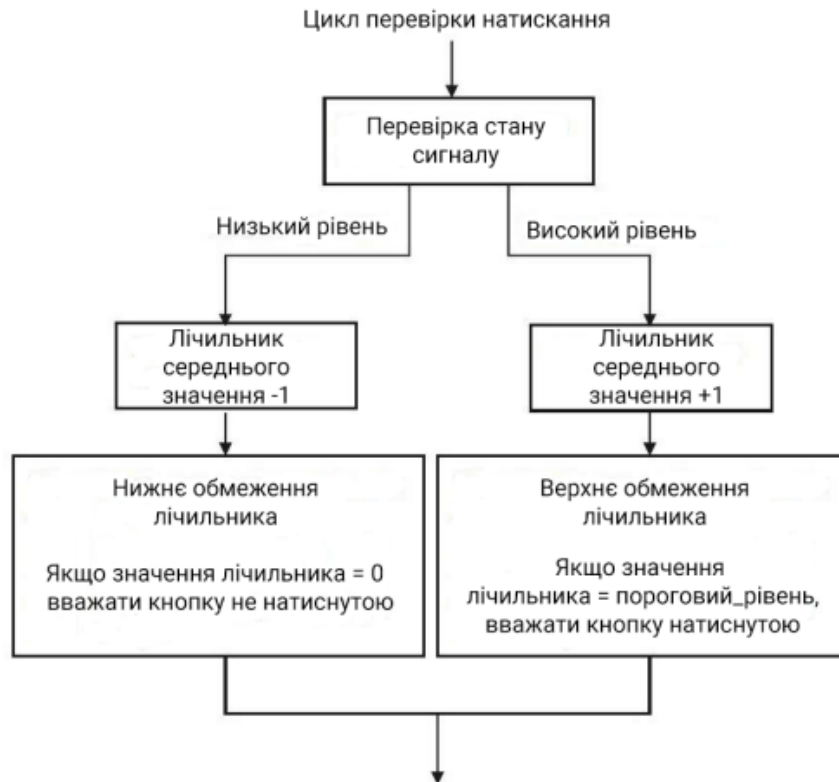
Рис. 2.7. Алгоритм усереднення сигналу кнопки
