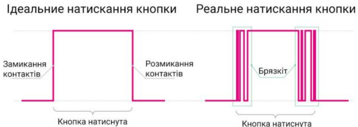
Рис. 2.4. Діаграма перемикання механічного контакту
