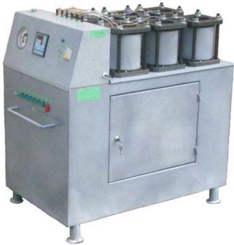
Рис. 1.79. Установка УФ-6 для випробування зразків бетону на водонепроникність
