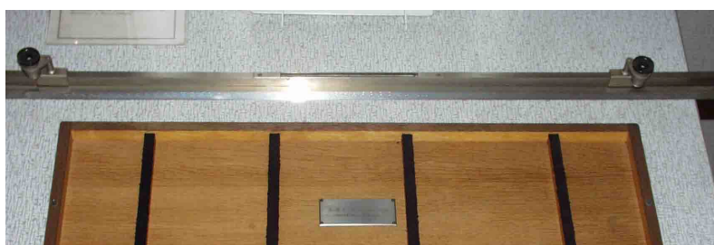
Рис. 1.1. Зразки засобів вимірювальної техніки (еталони), що використовувалися в Україні (експозиція музею НДЦ «Інститут метрології»). а – еталон ваги; б – еталон часу; в – еталон довжини.
