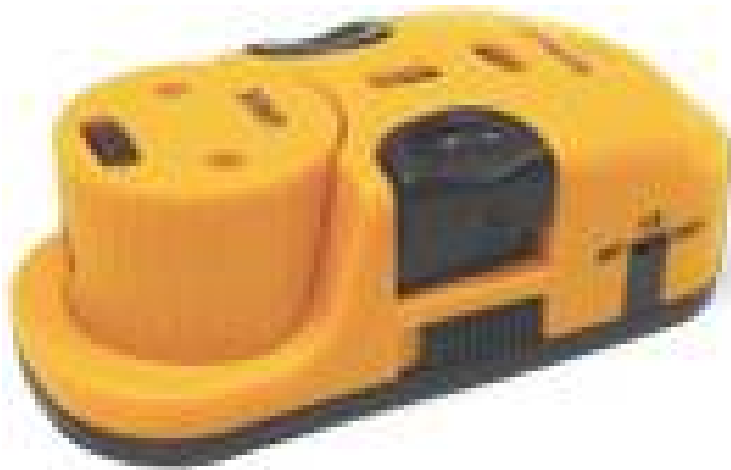
Рис. 1.42. Універсальний лазерний рівень-маркер з мультidetектором (пошук електропроводки і арматури) і кутоміром. Три варіанти випромінювання - горизонтальна лінія, хрест і точка.
