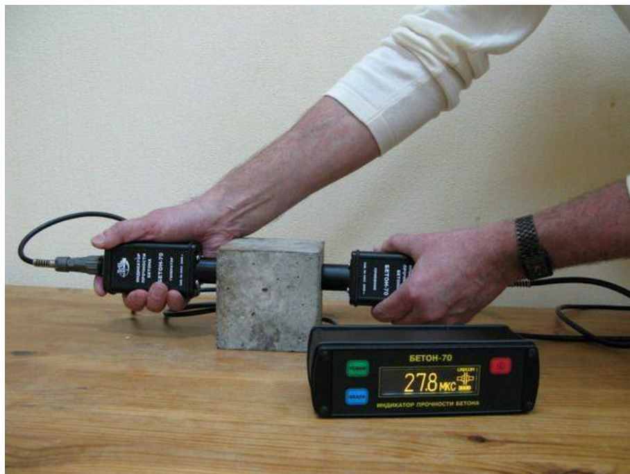
Рис. 1.73. Дефектоскоп ультразвуковий для визначення міцності бетону і цеглі БЕТОН – 70
