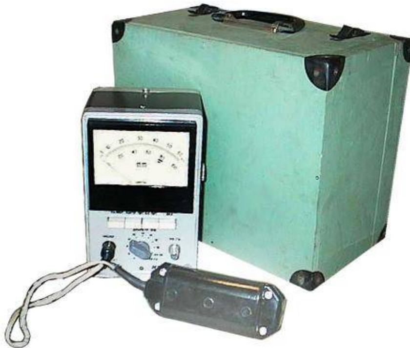
Рис. 1.94. Прилад ІЗС-10Н для контролю стану арматури в бетоні
