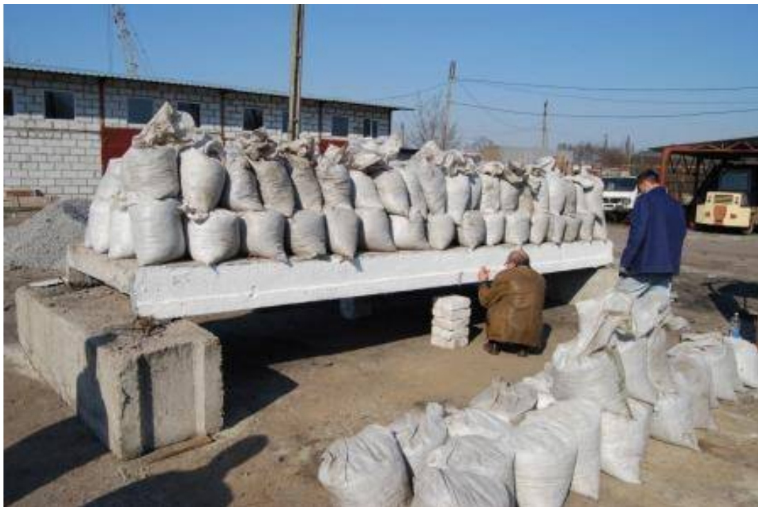
Рис. 1.62. Натурне випробування залізобетонної плити перекриття з поступовим збільшенням розподіленого навантаження
