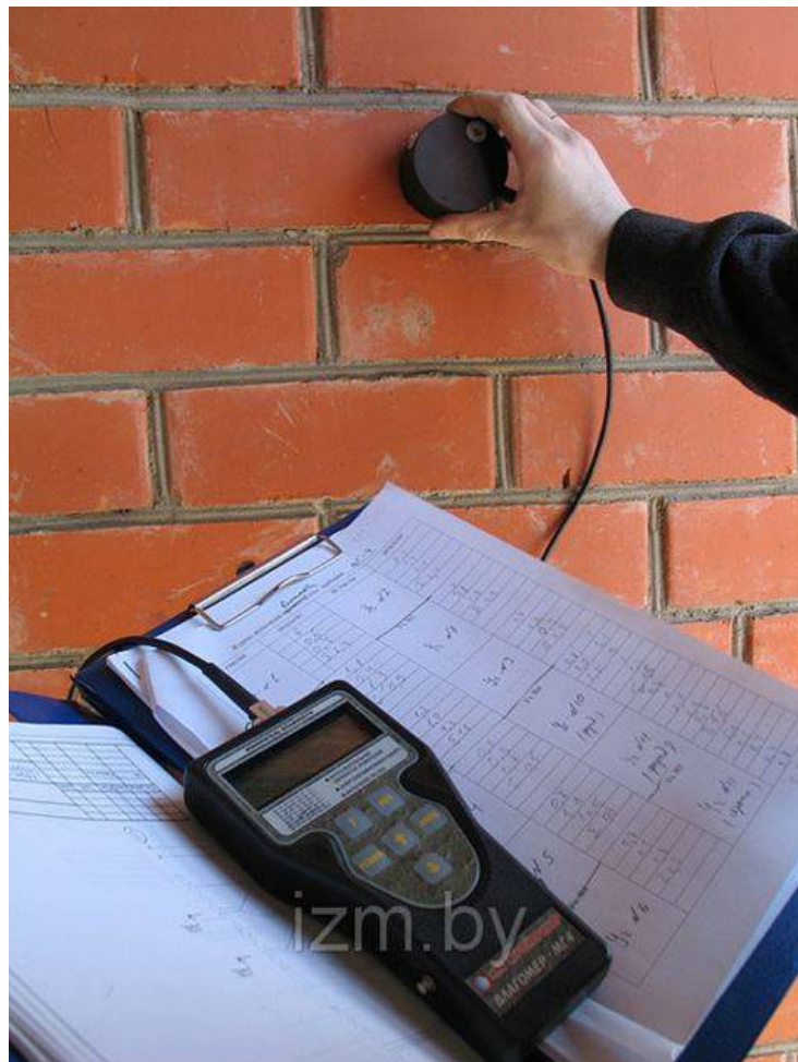
Рис. 1.77. Вологомір поверхневий (деревина, будматеріали)
