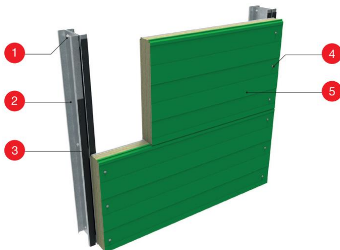
Рисунок 2.6 – Сендвіч-панель заводського виготовлення [6]:
