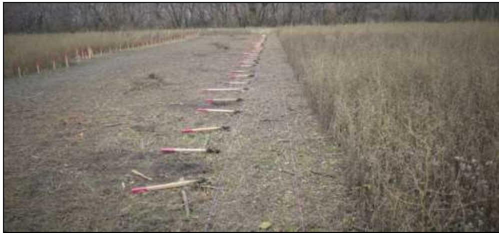
Рис. 22. Загальний вигляд Смуги очищення (розмінування), підготовленої для проведення пошуку ВВП та інших феромагнітних матеріалів за допомогою металодетектора
