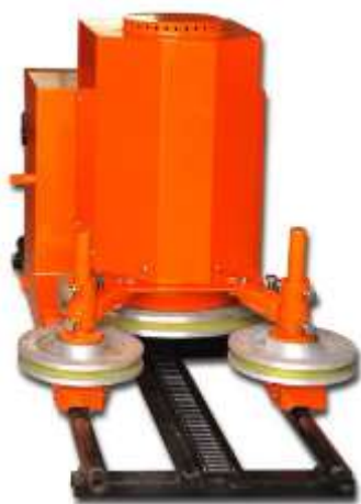
Рис. 3.25 Канатні машини QGM11G ... QGM22G
