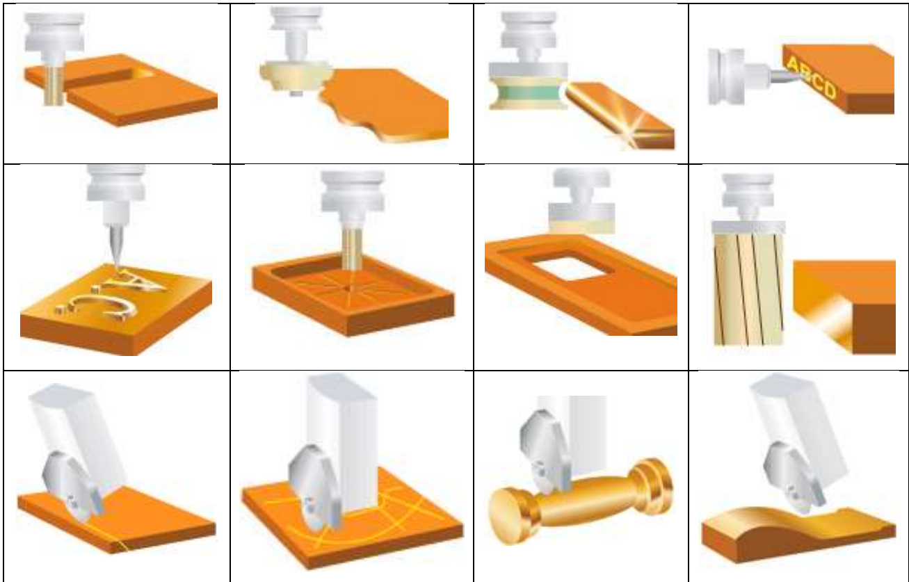
Рис 4.65 Схеми обробки на 5-вісному обробному центрі з ЧПК.
