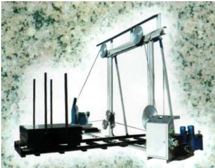
Рис. 3.28 Установка пасерувальна (Diamond wire blocktailor).
