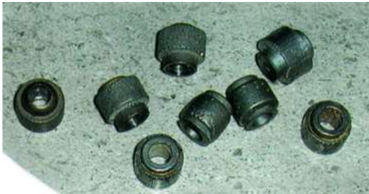
Рис. 2.25 Алмазно-канатні пили фірми TYROLIT для розробки кар'єрів та випилювання блоків з вапняку та мармуру.
