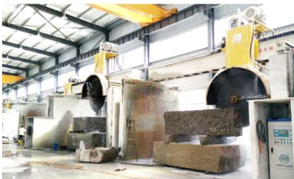
Рис. 4.42 Каменерізні верстати серії QSQ в умовах експлуатації (Xiamen Wanli Stone Co.).
