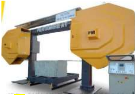
Рис.4.87 Мультиканатний верстат компанії Pellegrini
