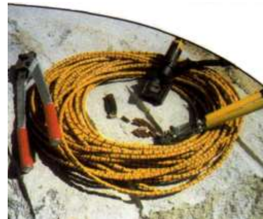
Рис. 2.25 Алмазно-канатні пили фірми TYROLIT для розробки кар'єрів та випилювання блоків з вапняку та мармуру.
