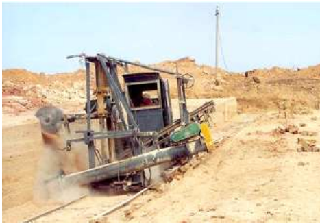
Рис. 3.4 Підшвоуступна дискова каменерізна машина
