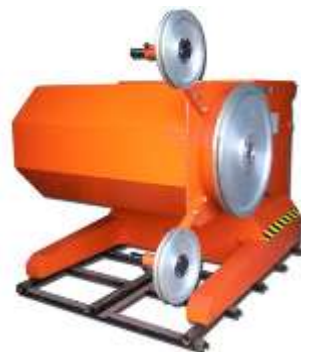
Рис. 3.26 Канатні машини QGM30G ... QGM75G
