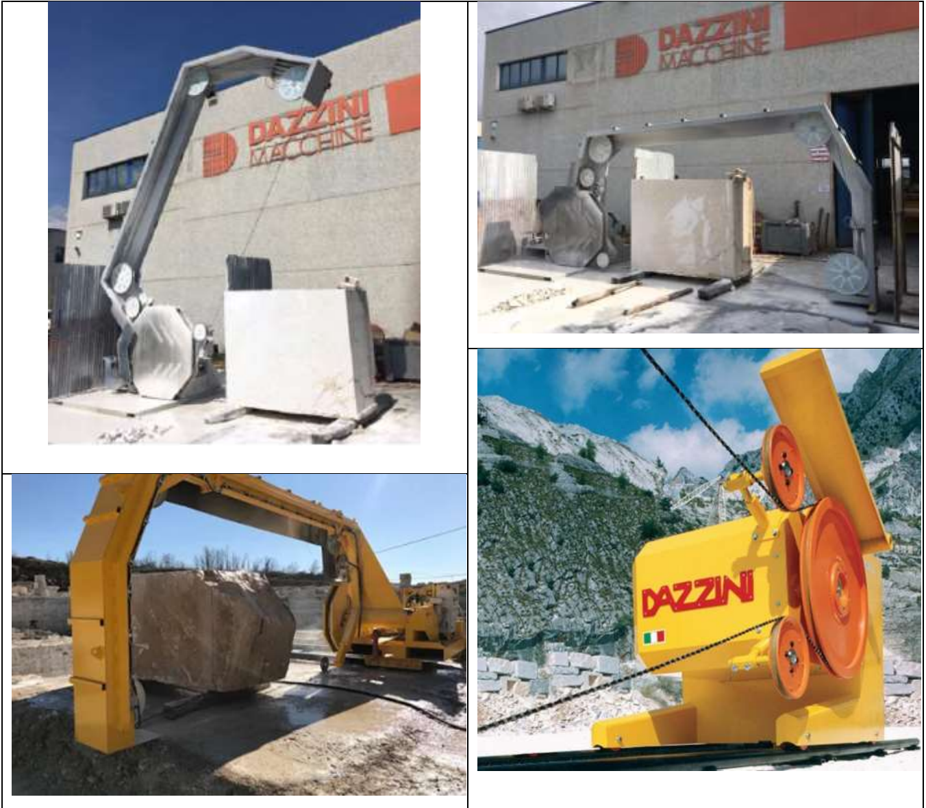
Рис. 4.74 Приклади одноканатних верстатів компанії DAZZINI MACCHINE, які можуть використовуватись на кар'єрах для розпилювання монолітів на блоки або блоків на сляби.
