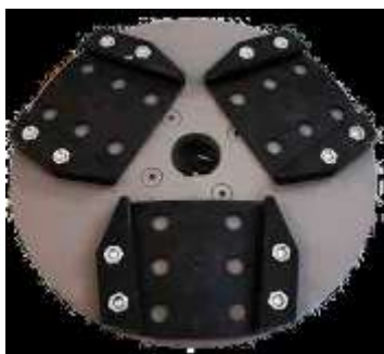
Рис. 4.115 Планшайба „Франкфурт“ (а – супорт, б – напрямні)
