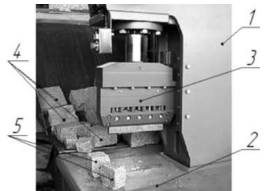
Рис. 5.11 Гідравлічний верстат для розколювання. Позначено: 1 – станина; 2 – робочий стіл; 3 – рухомий блок з комплектом з 10-ти ножів; 4 – гранітні заготовки; 5 – брущатка-виріб [32].
