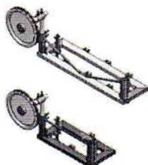
Рис. 9 Варіанти виконання напрямних роликів, маховиків, стійок
