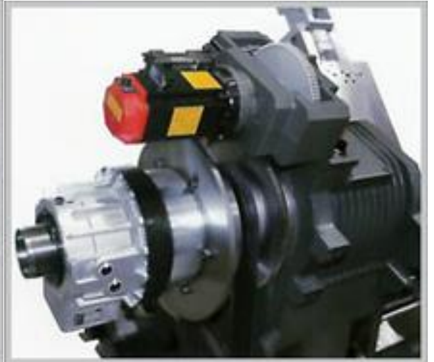
Рисунок 3. Шпиндельний вузол верстата VICTOR Vturt-A16 з передачею крутного моменту від електродвигуна на шпиндель через ремінну передачу.
