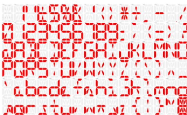
Рис.1.4 - Арабські цифри , літери базового латинського алфавіту ISO та знаки пунктуації на типовому 16-сегментному дисплеї
