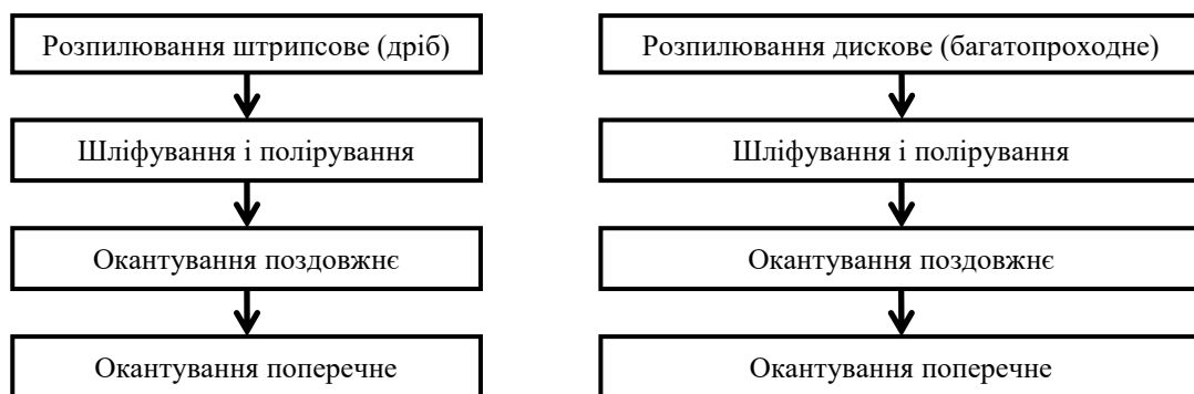
Рис. 1. Технологічні схеми виготовлення облицювальних плит з високоміцних порід
