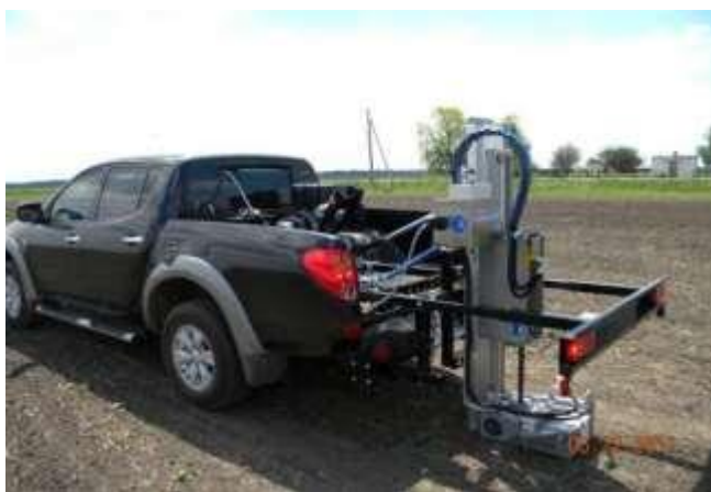
Рис.2.4. Відбір проб ґрунту автоматичним проповідбірником
