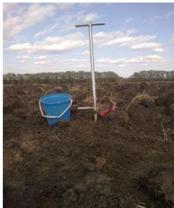
Рис. 2.3 Відбір проб буром з глибини 30 см
