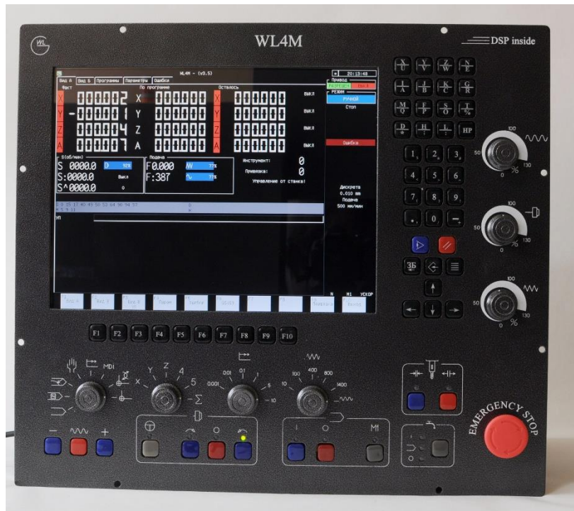
Рисунок 3.1 – Приклади пультів керування систем ЧПК з можливостями ручного вводу керуючих програм (HNC). а – пульт керування верстата з ЧПК системи Sinumerik 808D; б – пульт керування верстата з ЧПК системи iTNC-530; в - пульт керування верстата з ЧПК системи WL4M
