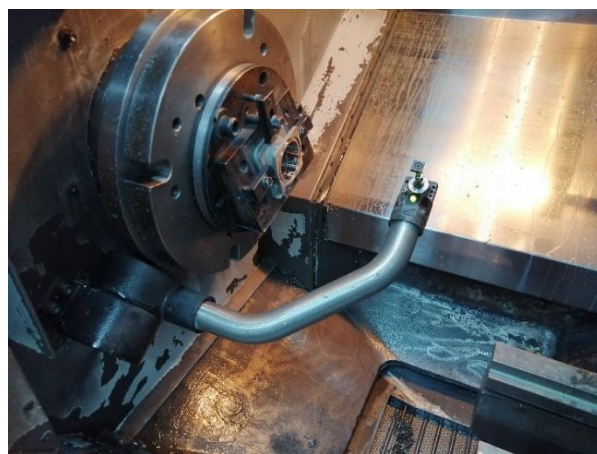
Рисунок 3.17 – Схеми вимірювання інструменту контактними вимірвальними приладами на верстатах фрезерної групи (а) і токарної групи (б)
