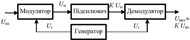
Рис. 5.10. Структурна схема ППС із перетворенням
