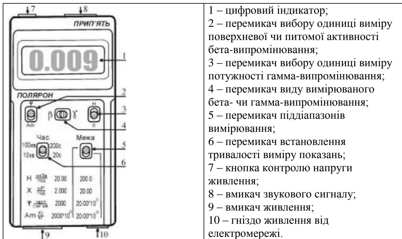
Рис. 2. Складові дозиметра бета-, гамма-випромінювання "Прип'ять":
