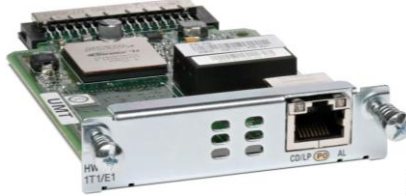
б) Cisco HWIC-1T1/E1 (последовний інтерфейс, рознім RJ-48)
