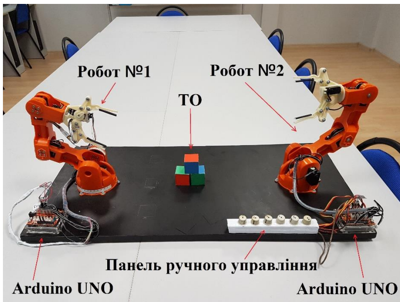
Рис. 2.29. – Загальний вигляд лабораторного стенду
