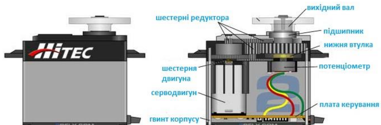
Рис. 2.5. – Внутрішня будова серводвигуна
