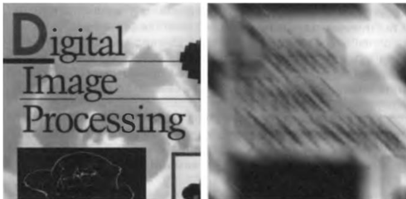
Рис.3.1.Викривлення зображень внаслідок руху відносно цифрової камери
