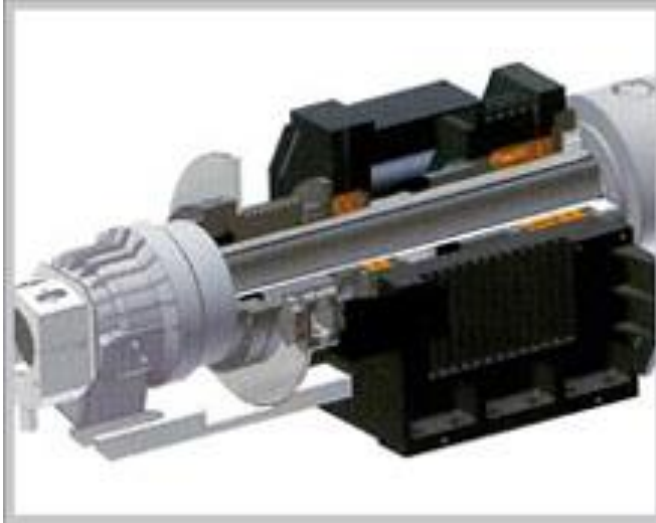
Рисунок 3. Шпиндельний вузол верстата VICTOR Vturt-A16 з передачею крутного моменту від електродвигуна на шпиндель через ремінну передачу.
