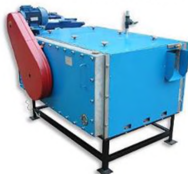
Рисунок 5.10 – Загальний вигляд картоплеочищувальної машини безперервної дії КНА-600М
