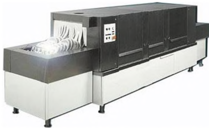
Рисунок 4.14 – Загальний вигляд посудомийної машини безперервної дії ММУ-2000
