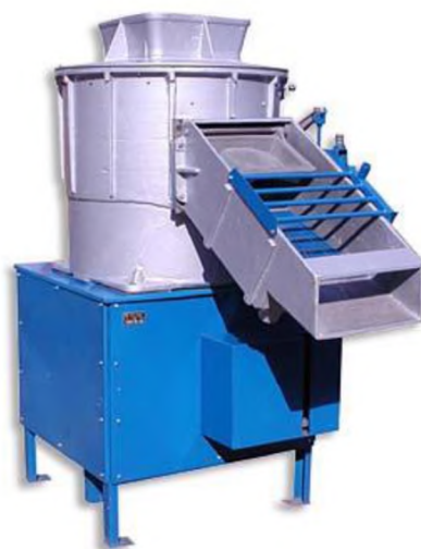
Рисунок 5.6 – Картоплеочищувальна машина МОК-1200
