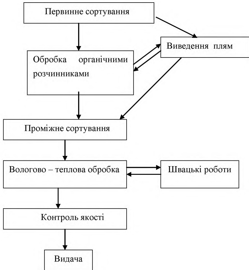
Технологічна схема обробки виробів методом «сухого» чищення на підприємствах хімічної чистки
