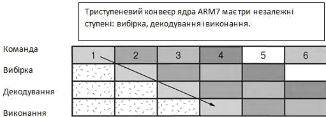
Рисунок 1 – Робота триступеневого конвеєра
