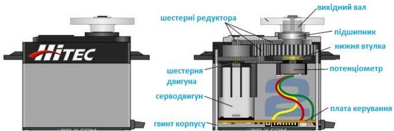
Рис. 2.5. – Внутрішня будова серводвигуна
