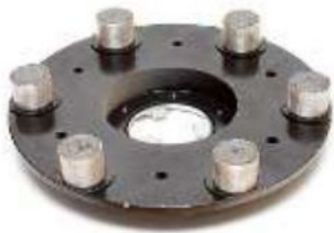
Рис. 2.58 Полірувальна планшайба із свинцем
