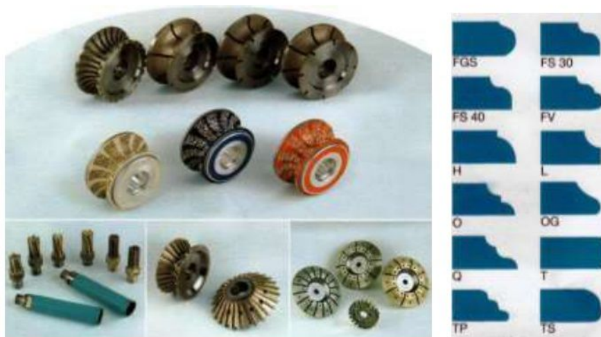
Рис. 2.37 Комплект фасонних алмазних фрез з металевим в'язучим фірми Tyrolit Vincent для верстатів з ЧПК для обробки мармуру й граніту.
