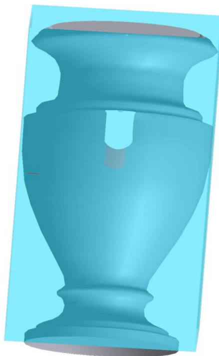
Рис. 2.11. Трьохвимірною моделлю заготовки і вази, яку планується отримати
