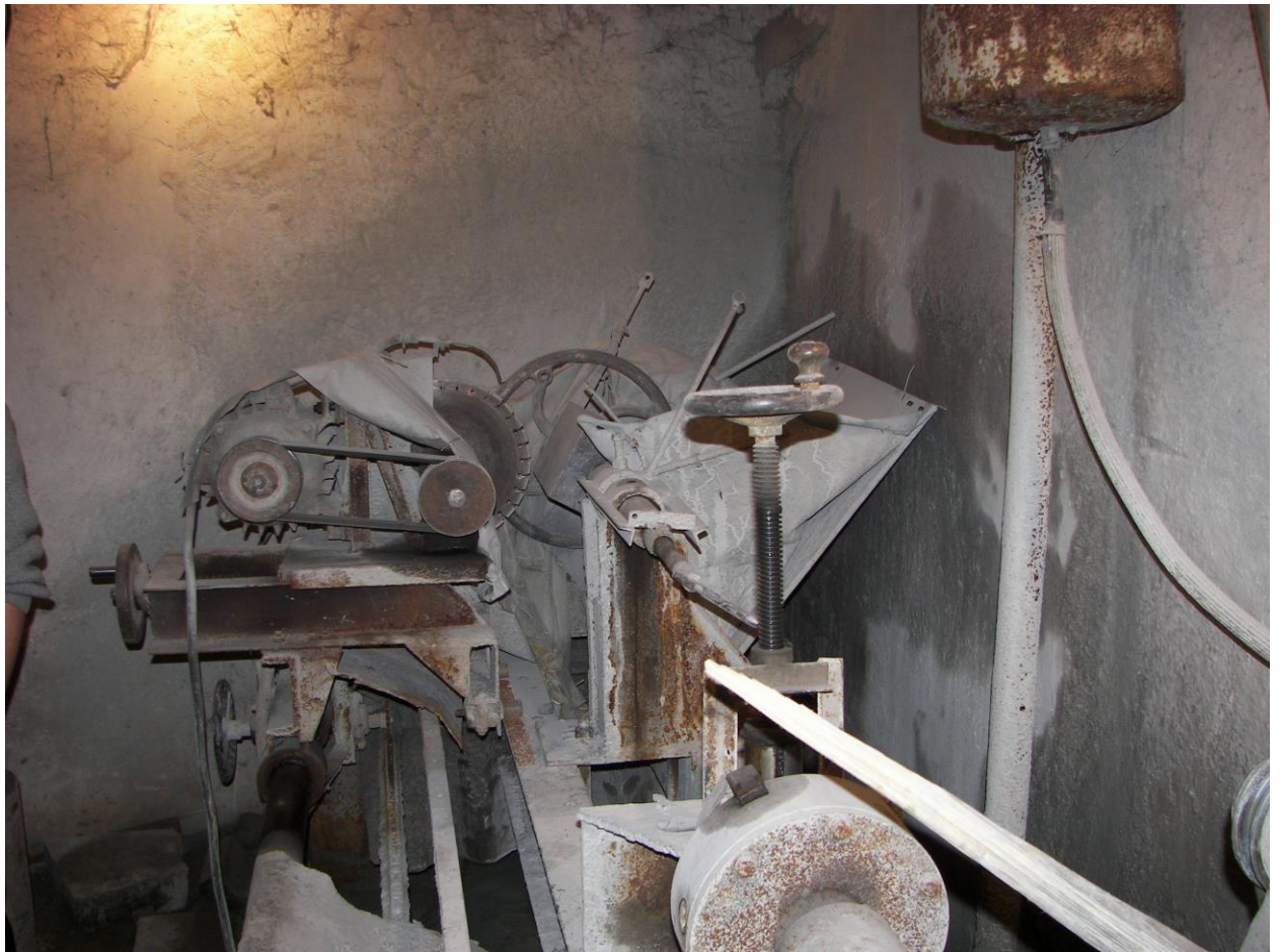
Рис. 2.1.Токарний верстат для виготовлення виробу з формою тіл обертання змінного перерізу (колони, балясини і т. ін.).
