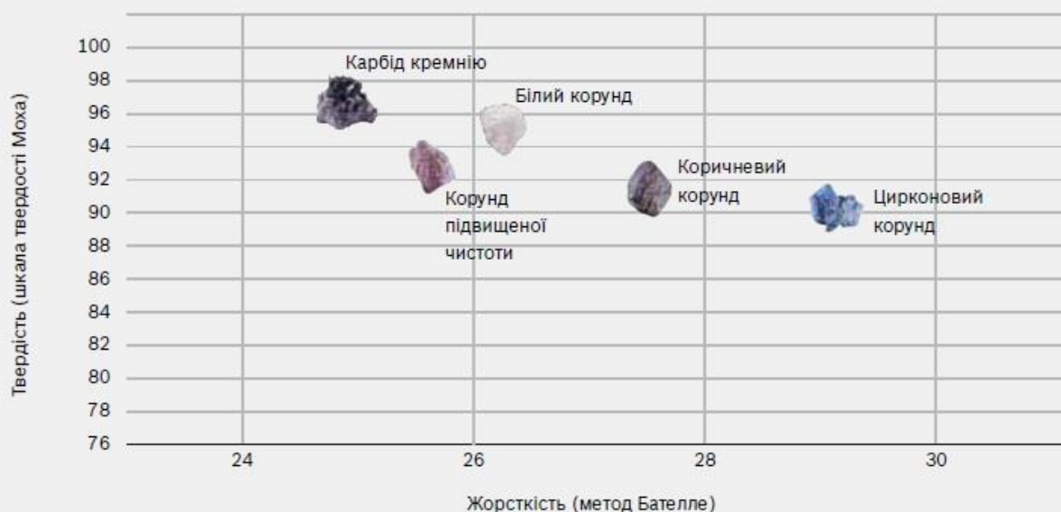
Рис. 1.9. Твердість та жорсткість шліфувального зерна
