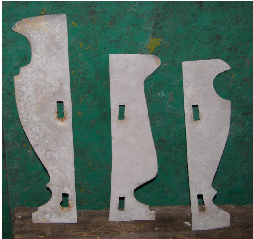
Рис. 2.2. Копіри, які використовуються для виготовлення виробу з формою тіл обертання змінного перерізу
