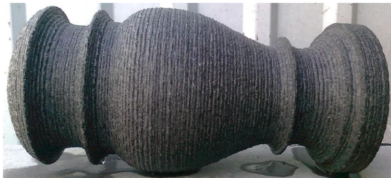
Рис. 2.5.Обточування заготовок до форми наближеної до проектної
