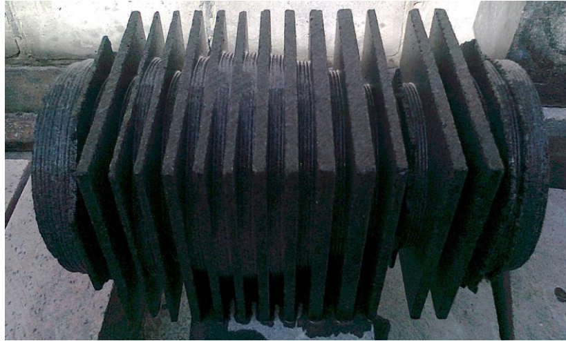
Рис. 2.3.Процес утворення відокремлених канавок-пропилів
