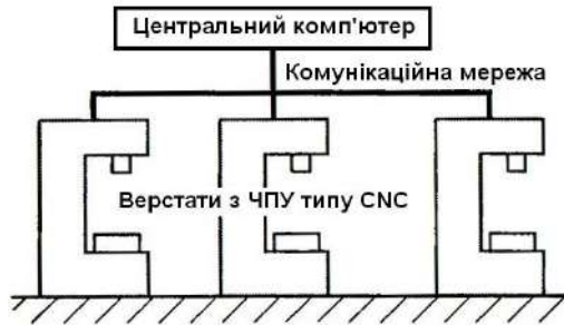
Рисунок 8.3 – Схема прямого числового управління
