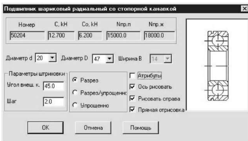
Рисунок 6.2 – Використання шаблону для вибору параметрів підшипника
