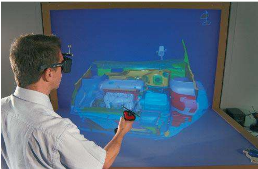
Рисунок 10.4 – «Віртуальне компонування» моторного відсіку автомобіля «Пежо-206»
