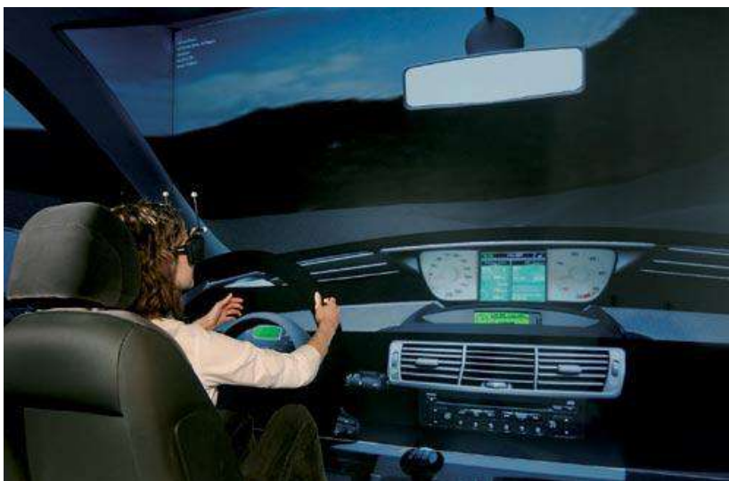
Рисунок 10.5 – «Віртуальна перевірка» зовнішньої оглядовості з місця водія
