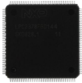
Рисунок 2.1 – Зовнішній вигляд мікроконтролера LPC2378 (вид зверху)
