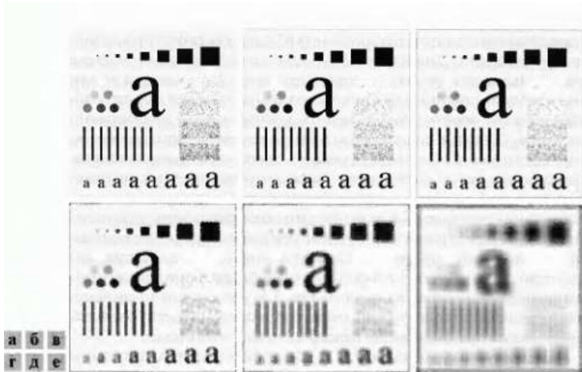
Рис. 3.35. (а) Исходное изображение размерами 500х500 элементов. (б)–(е) Результаты сглаживания усредняющим фильтром с квадратной маской размерами n = 3, 5, 9, 15, и 35 . Черные квадратики в верхней части имеют размеры 3, 5, 9, 15, 25, 35, 45, и 55 пикселей соответственно и расположены на расстоянии в 25 пикселей друг от друга. Буквы внизу изменяются в размерах от 10 до 24 пунктов, с увеличением каждый раз на 2 пункта; размер самой большой буквы — 60 пунктов. Вертикальные полосы имеют 5 пикселей в ширину и 100 пикселей в высоту; расстояния между ними — 20 пикселей. Диаметр кружков — 25 пикселей, и расположены они на расстоянии 15 пикселей друг от друга; их уровни яркостей изменяются от 0\% до 100\% черного с шагом 20\% . Общий фон изображения — 10\% черного. Прямоугольники с шумом имеют размеры 50 \times 120 пикселей.
