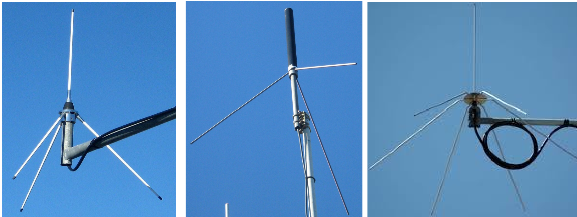
Чвертьхвилові несиметричні вібраторні антени з противагами (часто її називають “Ground plane”, GP)
