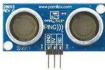
Рисунок 7.1 – Зовнішній вигляд ультразвукового датчика відстані
