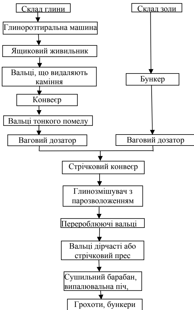
Рис. 25. Технологічна схема виготовлення глинозольного гравію
