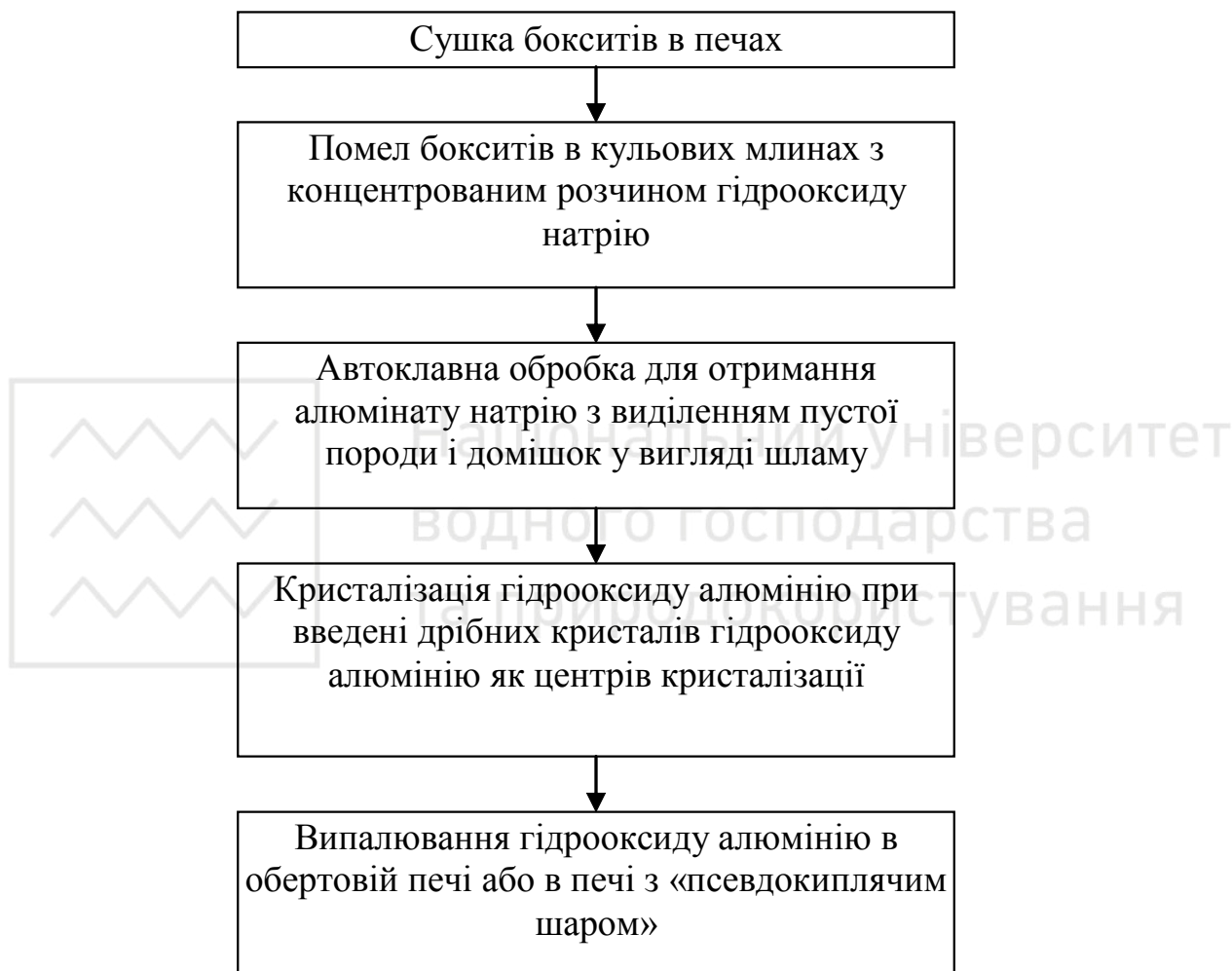
Рис. 2.4. Загальна схема виробництва глинозему з бокситів
