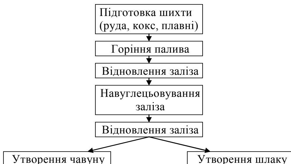
Рис.2.1. Основні етапи процесу виплавлення чавуну та утворення доменного шлаку
