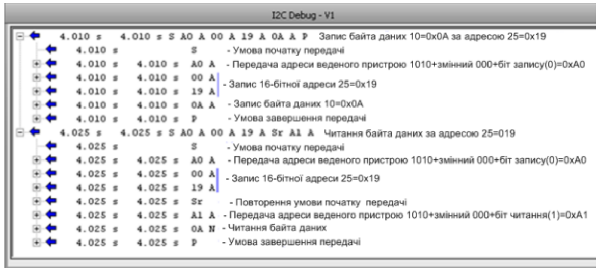
Рисунок 3 - Пояснення окремих етапів обміну шиною TWI (I2C)
