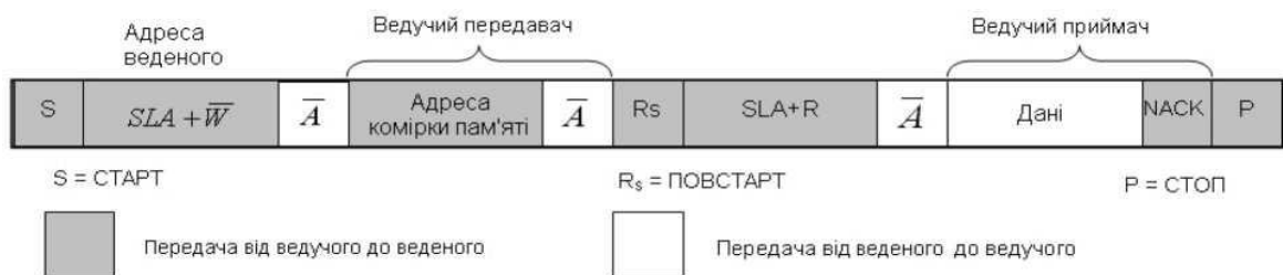
Рисунок 5 - Приклад звернення до зовнішньої пам'яті даних типу EEPROM
