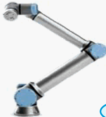
Кобот UR5 . Вантажопідйомність: 5 кг. Радіус дії: 850 мм.
