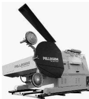
Рис. 49. Алмазно-канатна установка фірми Pellegrini модель TELEDIAM 120 super
