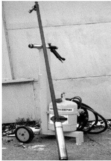
Рис. 80. Загальний вигляд термогазоструминної установки "Тайфун"
