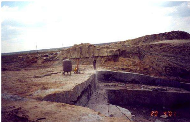
Рис. 73. Використання термогазоструминної технології на Покостівському гранітному кар'єрі
